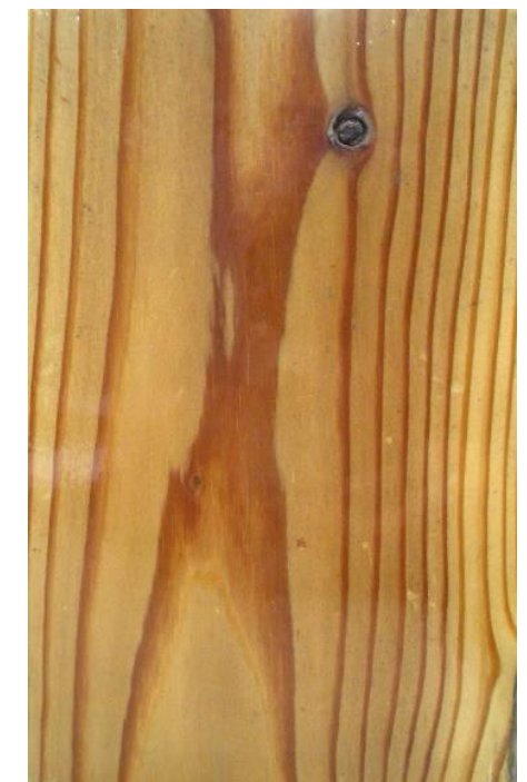
カラマツ材 屋外曝露 3 年間 塗膜の割れ・膨れ・剥がれ・ 白化等の劣化は見られない。
